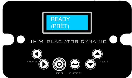
mode de fonctionnement de la machine. Vous pouvez choisir les modes OFF (arrêt, corps de chauffe éteints), STANDBY (corps de chauffe allumés), TIMER (TEMPORISATEUR) ou CONTINUOUS (CONTINU).
