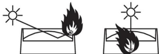
Lichtquelle aus. Stellen Sie sicher, dass der Kopf immer von der Sonne und anderen potentiellen starken Lichtquellen weg zeigt, auch wenn das Gerät nicht verwendet wird.
